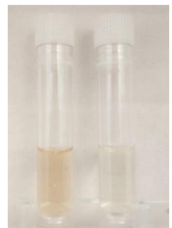
Abb. 1 Sichtbare Anzeichen für Oxidation. Links: Braunfärbung der Probe in Abwesenheit von Oxidations-Inhibitoren. Rechts: die gleiche Probe bei Nutzung des CyStain OxProtect Kits.
