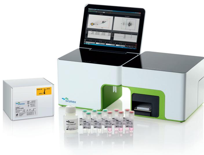
**Bild 4:** CyFlow™ Cube 6 V2m Flowzytometer mit Autoloader und dem CyStain™ BacCount Viable Kit
