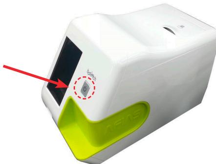
4. Wenn Sie den Netzschalter drücken, zeigt AFIAS-1 das Boditech-Logo an und führt eine Reihe von Systeminitialisierungs- und Selbstüberprüfungsroutinen aus.
