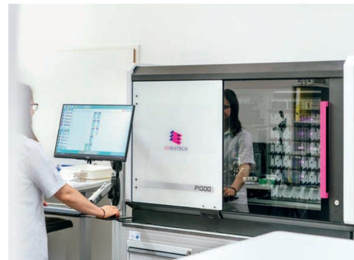
Labormitarbeiter nutzen ein vollautomatisches Scannerprofil, das die Proben in die Cloud speichert und dort mittels KI-Algorithmen analysiert. Die Ergebnisse werden über einen Standardbrowser in der CytoProcessor®-Software dargestellt.
