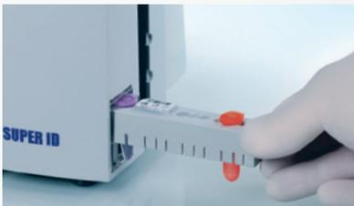
3. Probenbecher und Reagenzriegel in die Probenkassette setzen – fertig.
