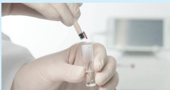
Die Cartridge mit der Probe zusammenstecken und mischen.
