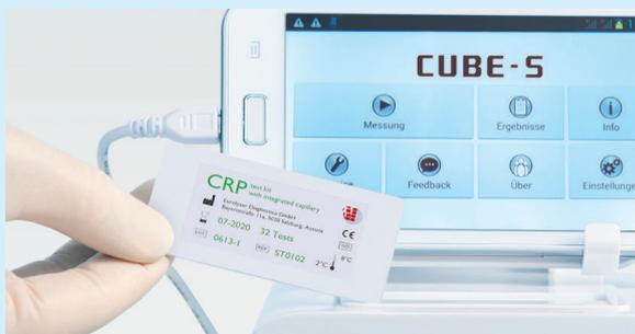
Einfach die reagenzspezifische RFID-Karte auflegen. Damit erkennt das System, welcher Test gemessen werden soll.
