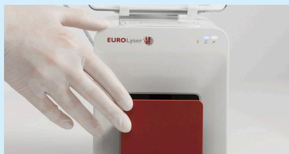
Die Cartridge in das System setzen, die Tür schließen – der weitere Testablauf erfolgt automatisch.
