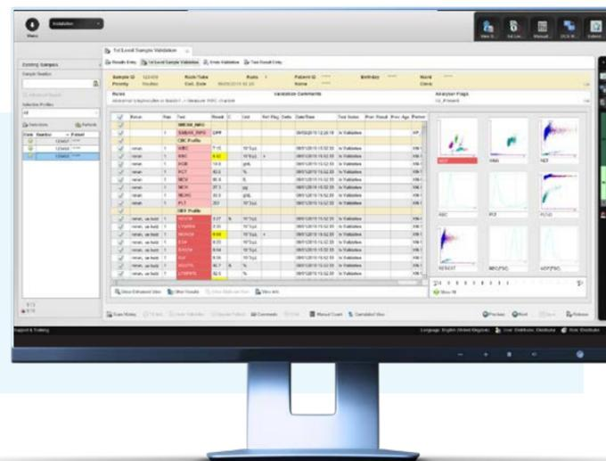
Abbildung einer technischen Validation der Extended IPU. An diesem Beispiel wird gezeigt, dass die beteiligten abnormalen Parameter hervorgehoben werden (rot, gelb). Verletzte Regeln werden aufgelistet und betroffene Scattergramme markiert, um den Benutzer sofort zu den verdächtigen Ergebnissen zu führen.
