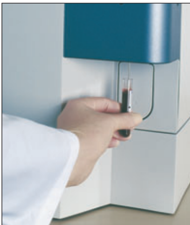
Abb. 5: Im XS-800i können die Blutproben nur manuell und offen gemessen werden, was speziell bei minimalen Blutmengen von Vorteil ist.
