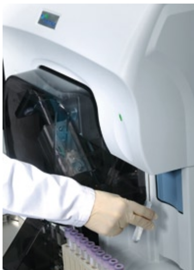
Abb. 2 Messung von Körperflüssigkeiten am XT-4000i mit integriertem Body-Fluid-Modus
