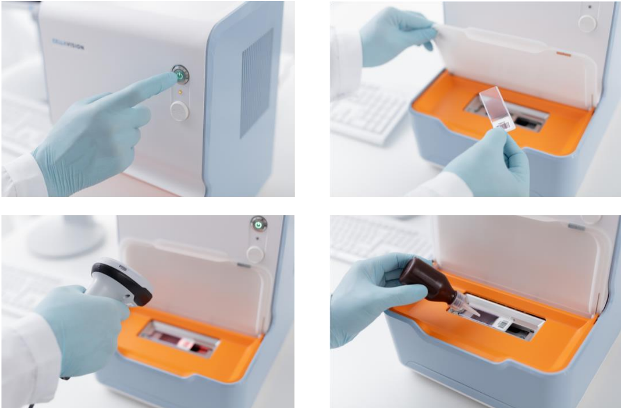
Abbildung 2: Handhabung des DC-1: Einschalten, Objektträger einlegen, Barcode scannen, Zugabe des Immersionsöls
