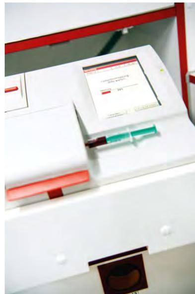
Die Blutprobe wird mit handelsüblichen Kapillaren oder Spritzen appliziert. Eine automatische Probenaspiration und Luftblasendetektion schließen Anwenderfehler aus
