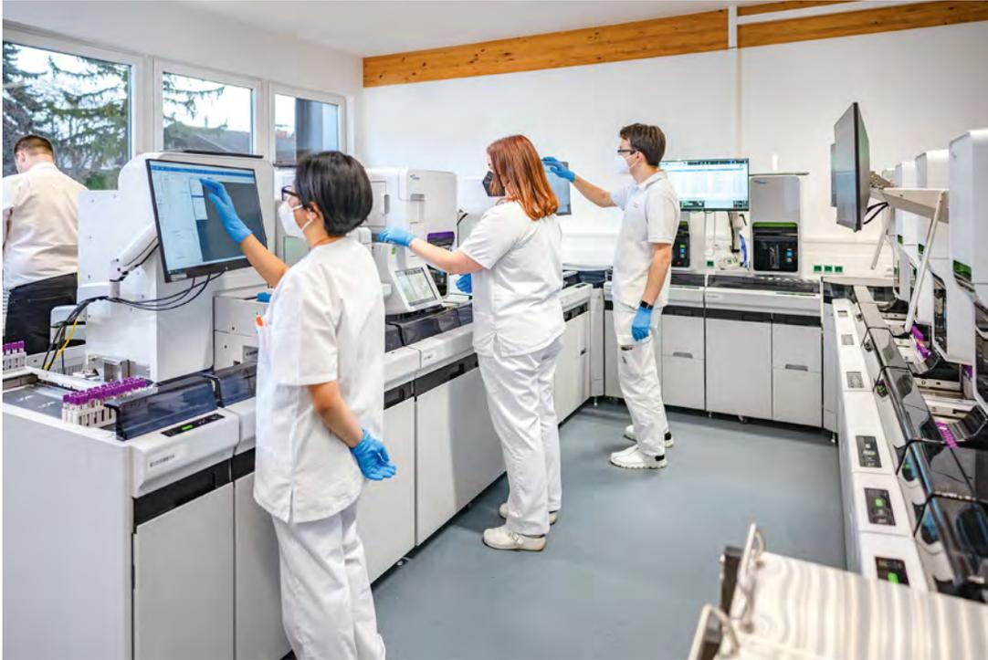
Dank der U-Form kann das Labor nun die zeitsparenden Vorteile des Systems nutzen. Denn der händische Probentransport entfällt und Blutausstriche lassen sich nun im Handumdrehen vollautomatisch erstellen
